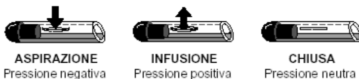
Fig.3, valvola a 3 posizioni dei cateteri Groshong
